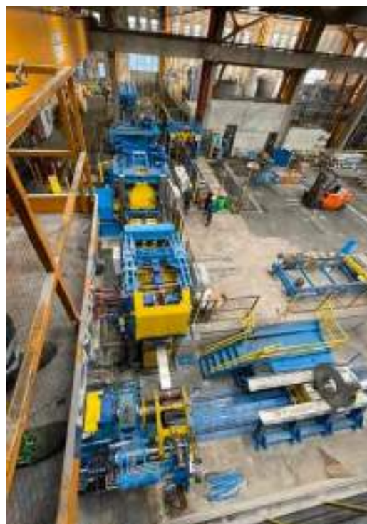
Plant di Civate - Impianto di spianatura e bandellatura con confezionamento automatico
